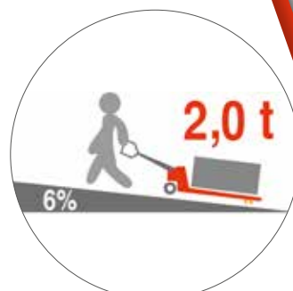
6% Steigfähigkeit bei Volllast
