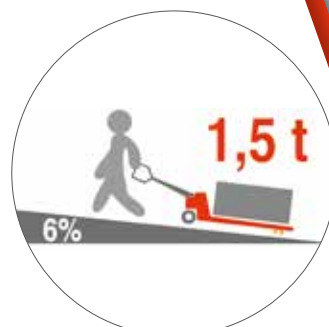
6% Steigfähigkeit bei Volllast
