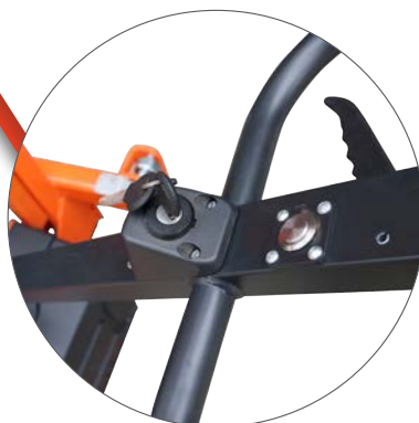
Deichsel mit Schlüsselschalter und Signaltaste
